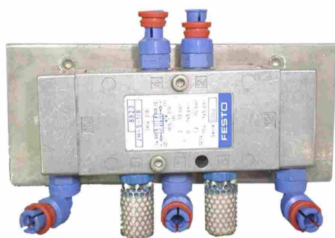
zawór rozdzielający 5/2 obustronnie sterowany ciśnieniem narastającym
