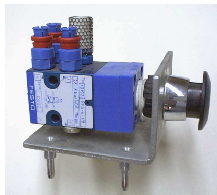
zawór rozdzielający 4/2 sterowany mechanicznie za pomocą przycisku
